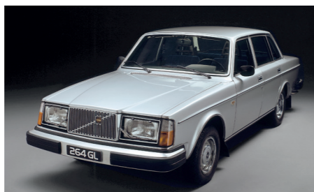
Met zijn krachtige V6-motor was de robuuste 264 een prima basisvoertuig voor ombouw tot ambulance.
