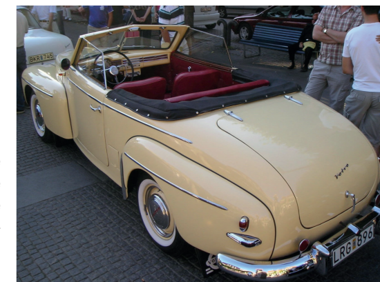
Het plaatwerk van de achterzijde werd geheel met de hand geklopt.
