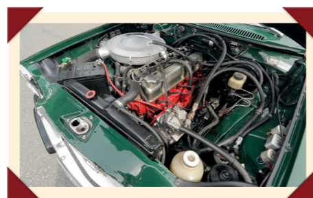
Onder de kap ligt de B30F, de lagecompressieversie van Volvo's zescilinder die was bedoeld voor de Amerikaanse markt.
