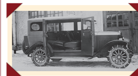
De banken in het interieur konden tot een soort bed worden neergeklapt.
