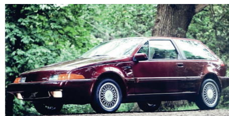
Sommige naar de VS verscheepte pre-seriemodellen waren voorzien van speciale velgen met spaakdesign.
