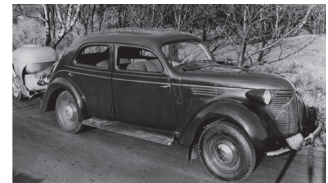
Om de voortrein te ontlasten werd de houtgasgenerator als aanhangwagen achter de auto meegetrokken.
