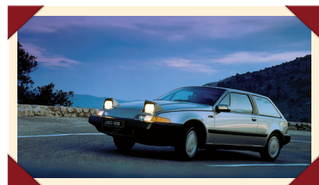
De klapkoplampen maakten het mogelijk aan de strenge Amerikaanse veiligheidsnormen te voldoen.
