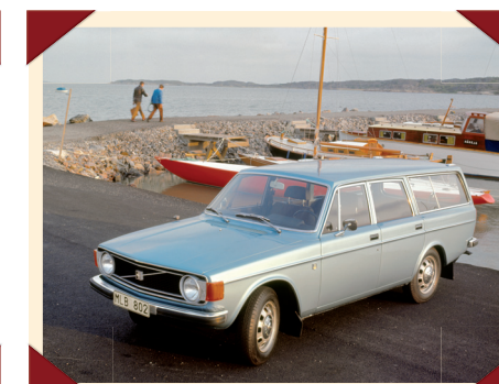
In 1973 kreeg de 140-serie een nieuw front met zwarte kunststof grille en grotere richtingaanwijzers.
