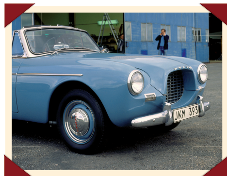
De wat vreemde vorm van neus was mede een gevolg van het materiaal waarvan de carrosserie werd gemaakt.
