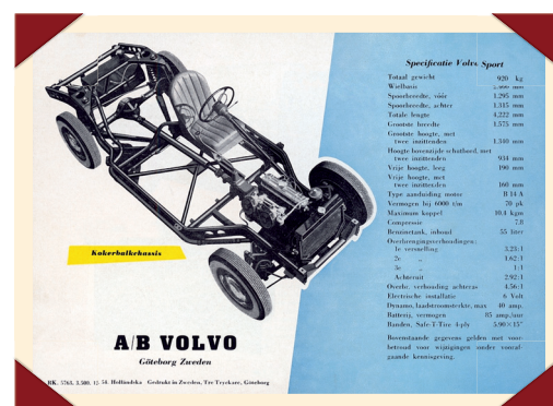
Het buizenchassis was volgens sommige testrijders te slap.
